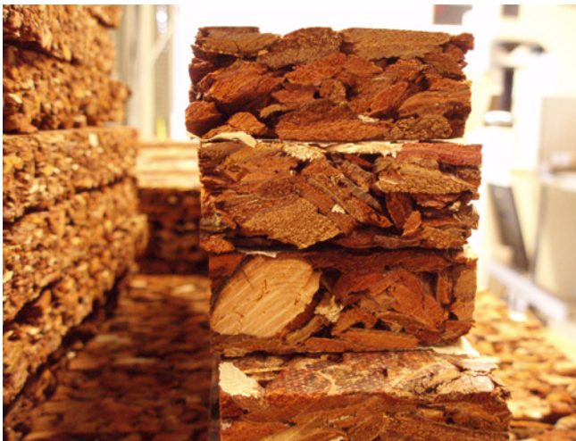
Abb. 1: Rindendämmplatte (Dicke = 20 mm, Dichte = 450 kg/m 3 )
