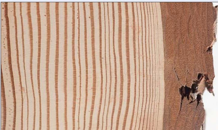
**Ausschnitt aus dem Querschnitt eines Lärchenblockes. Holz ist ein natürliches heterogenes Material – profundes Material- und Verarbeitungswissen ist für dessen Einsatz unerlässlich.**
