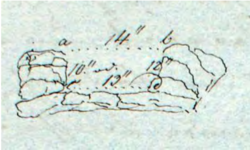
Abbildung 48: Querschnitt durch eine gemauerte Künette, Zeichnung J. G. Ramsauer 1853
