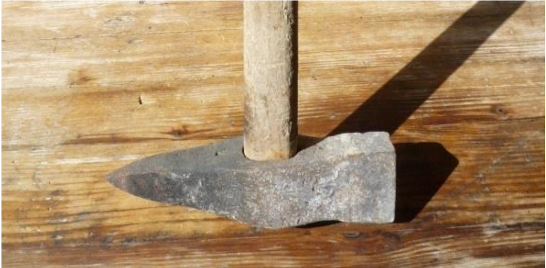
Abbildung 15: Schellhammer mit Spitz- Foto Kain
