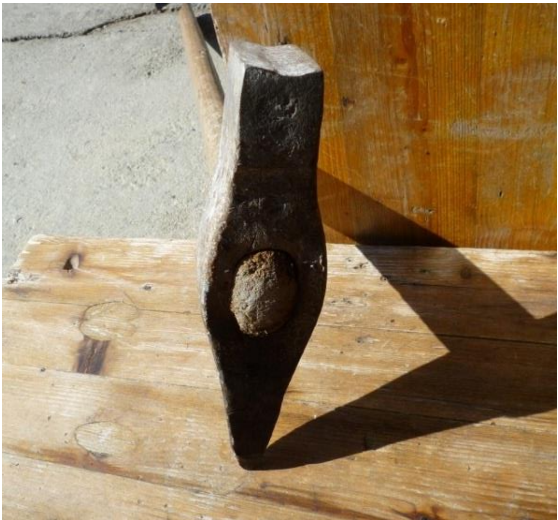
Abbildung 16: Schellhammer mit Spitz- Foto Kain
