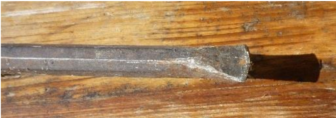
Abbildung 9, Bohrmeißel, einschneidig.– Foto Kain 2014.
