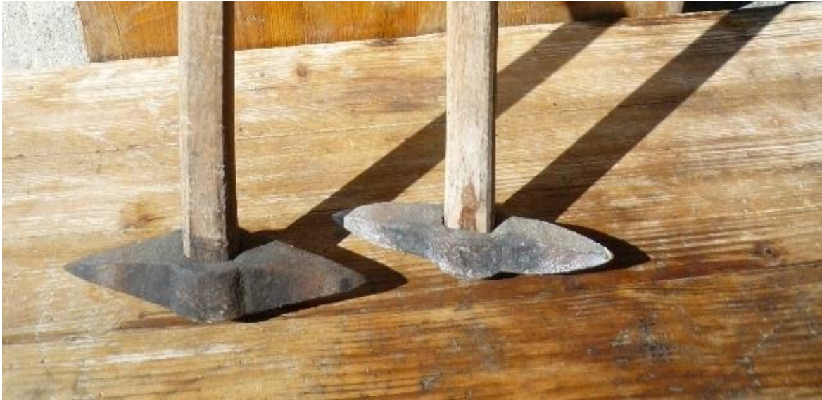
Abbildung 14: Zweispitz verschiedener Größe- Foto Kain
