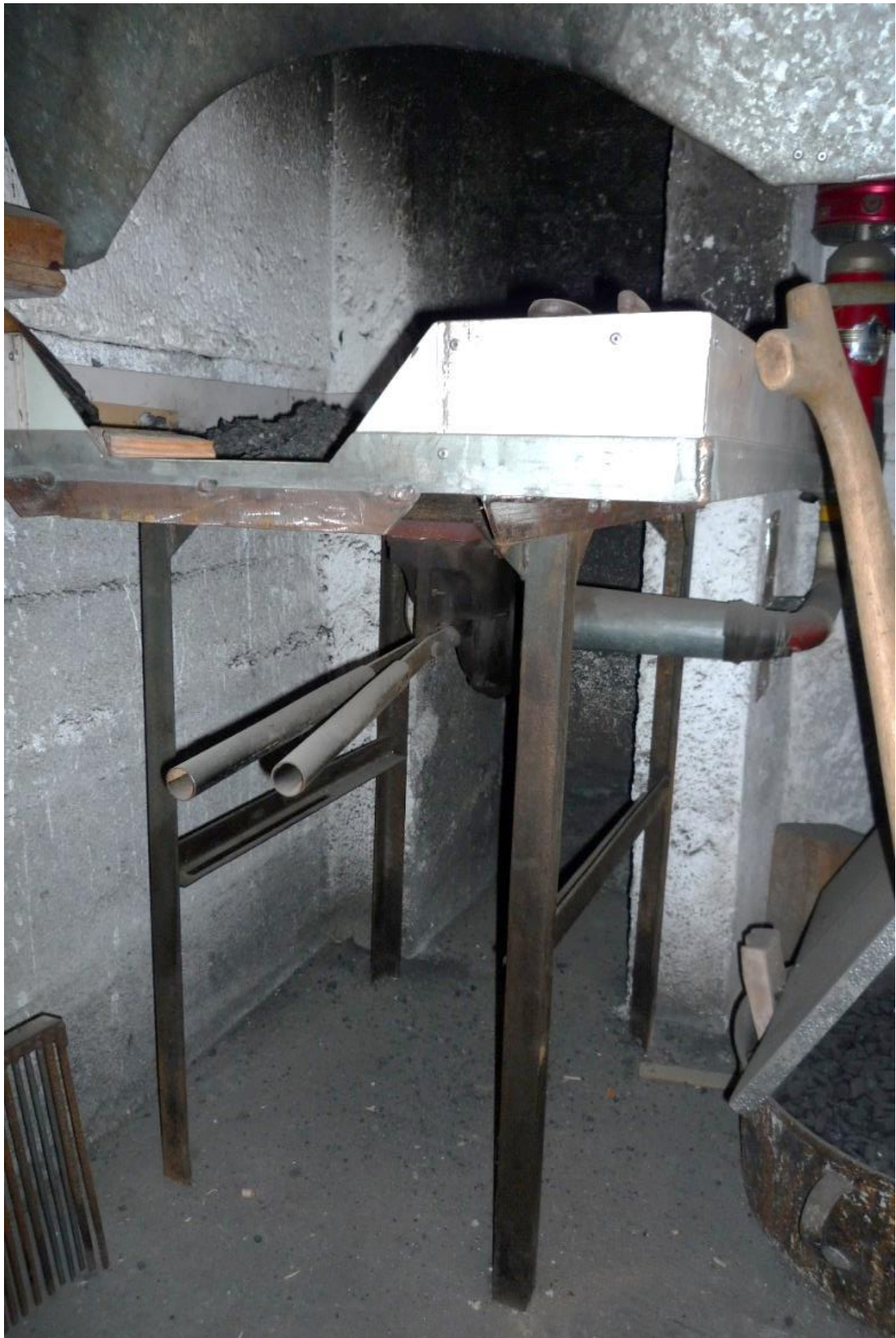
Abbildung 18: Feldschmiede wie sie vor Ort eingesetzt wurde – Foto Kain.
