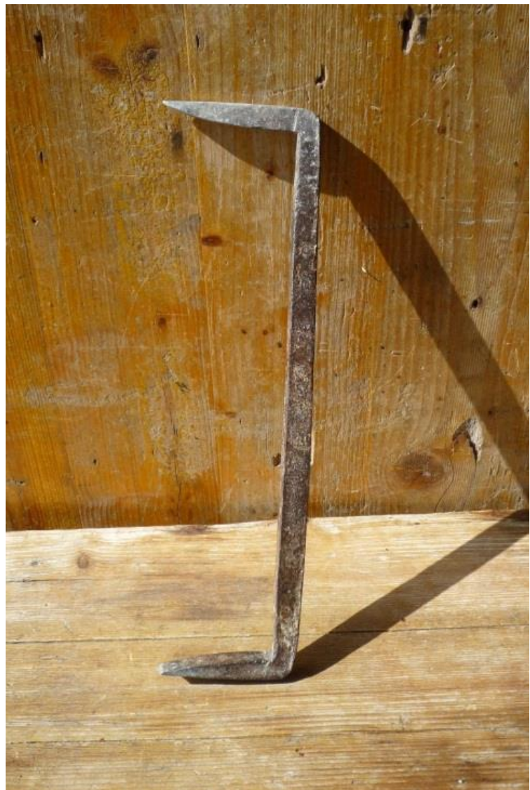
Abbildung 35, Klampfe zum Fugenauskratzen - Foto Kain 2014.
