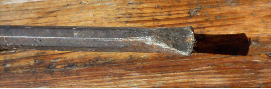
Abb. 9: Bohrmeißel, einschneidig (Foto: Kain 2014).
