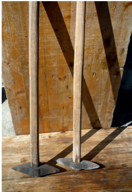
Abb. 14: Zweispitz verschiedener Größe (Foto: Kain).
