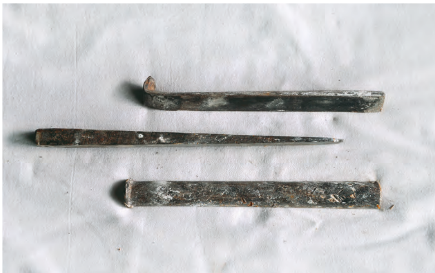
Abb. 11: Federkeile (Foto: Idam 2014).
